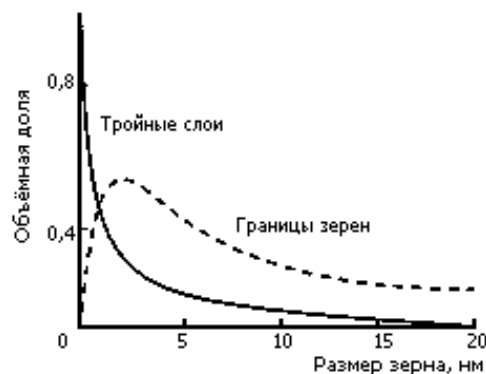
Рис. 11. Зависимость объемной доли границ зерен и тройных стыков от размера зерна (при толщине границы зерна 1 нм) [23].
